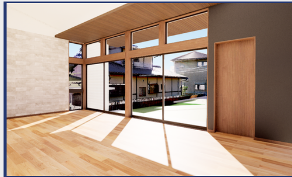
上記画像は点群を活用した太陽光シミュレーションの実際の操作画面。 窓の外の隣家がレーザースキャナーで取得した点群データ。
